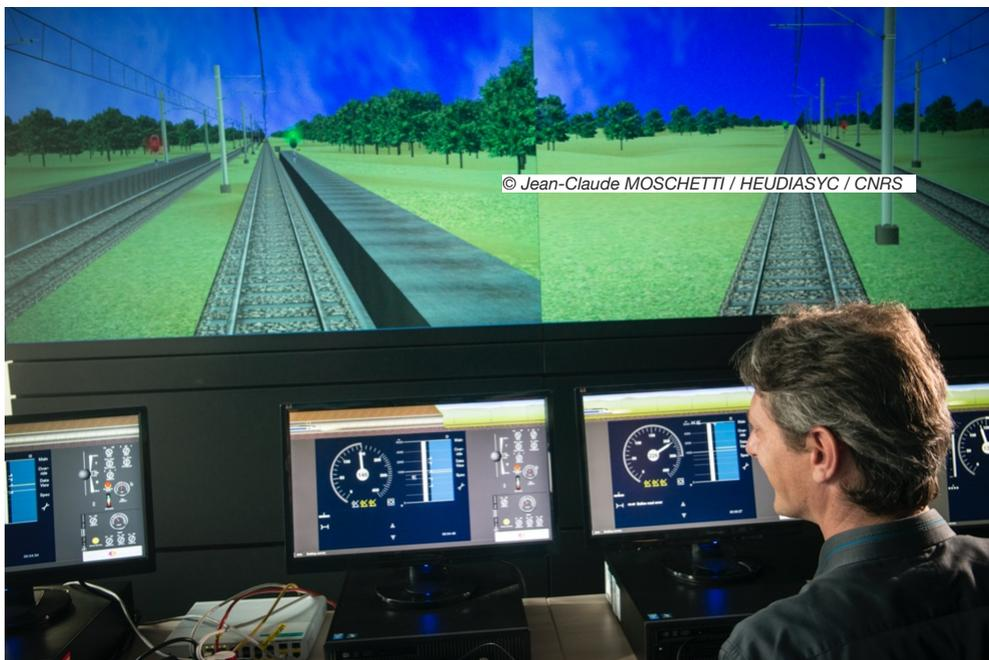
Figure 1. Simulateur de conduite ferroviaire sous système ERTMS utilisé dans le cadre des recherches du laboratoire Heuristique et Diagnostic des Systèmes Complexes (Heudiasyc) sur le facteur humain dans la prise en compte des incertitudes et la sûreté de fonctionnement des systèmes (2017).
